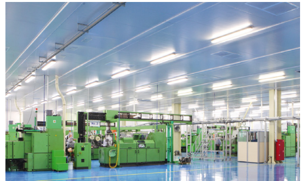
Produktionshalle mit Leuchtstoffröhren
