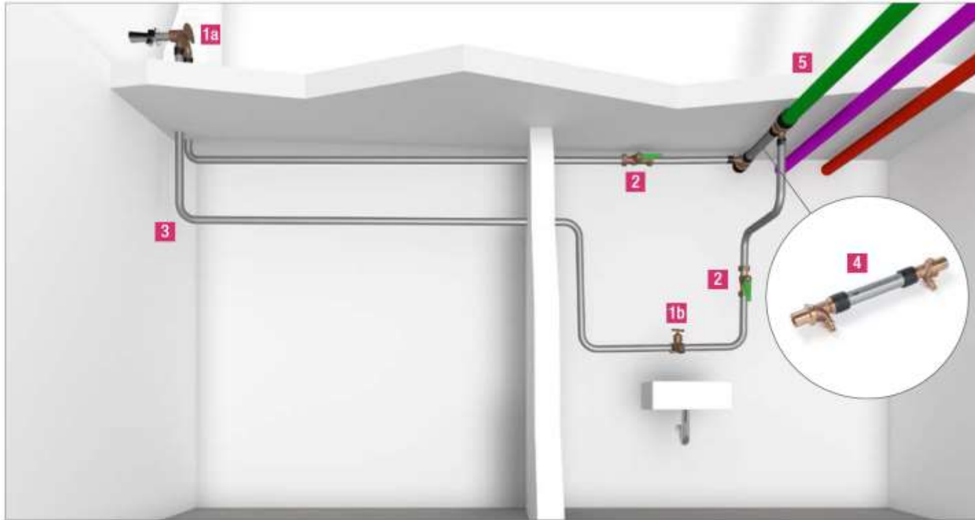
Abb. 4-5 Anbindung von Gartenwasseranschluss und Ausgussbecken im Keller
