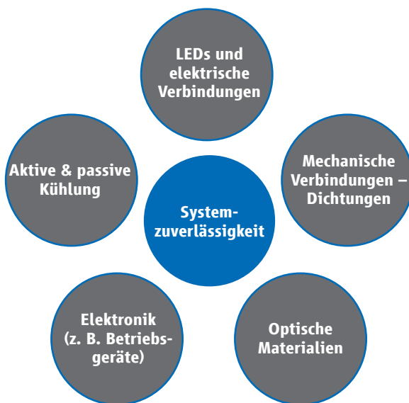
Abb. 14: Einflussfaktoren der Systemzuverlässigkeit
