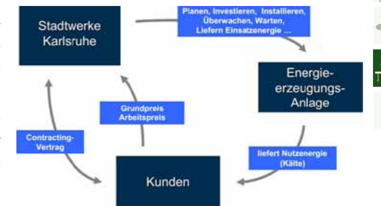
Abbildung 48: Kältelieferung im Contracting
