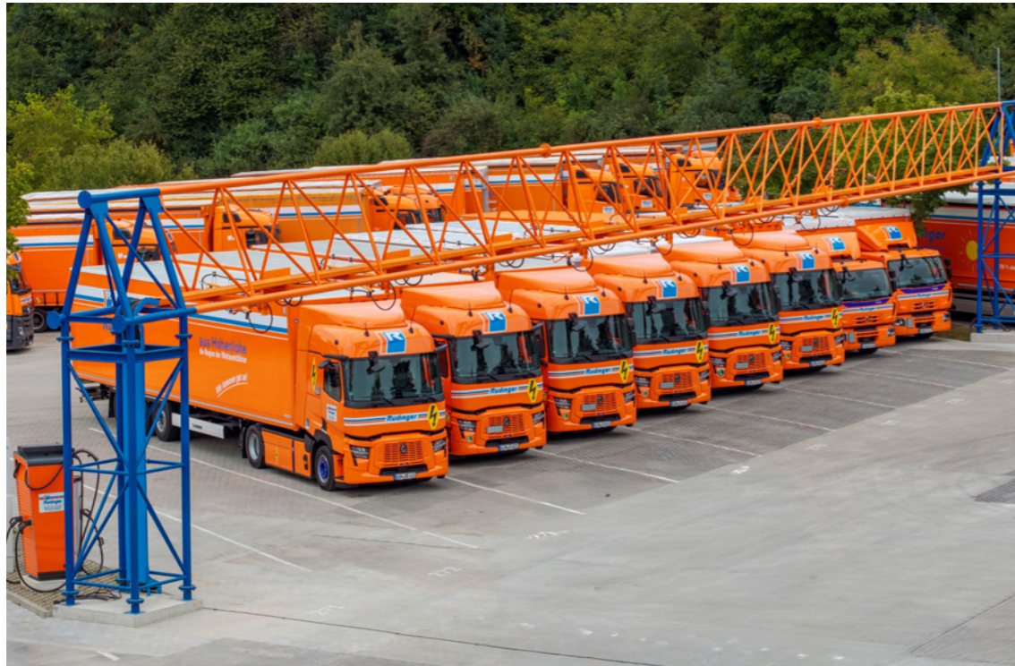
Abb. 13: Elektrische Renault Lkw der Spedition Rüdinger laden auf dem Betriebshof. (Quelle: Andreas Martin/Rüdinger Spedition GmbH)
