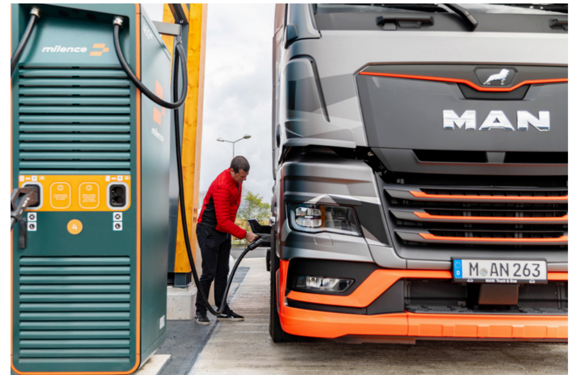
Abb. 4: Aufladen eines batterieelektrischen Lkw an einer Ladesäule von Milence. (Quelle: MAN Truck & Bus SE)
