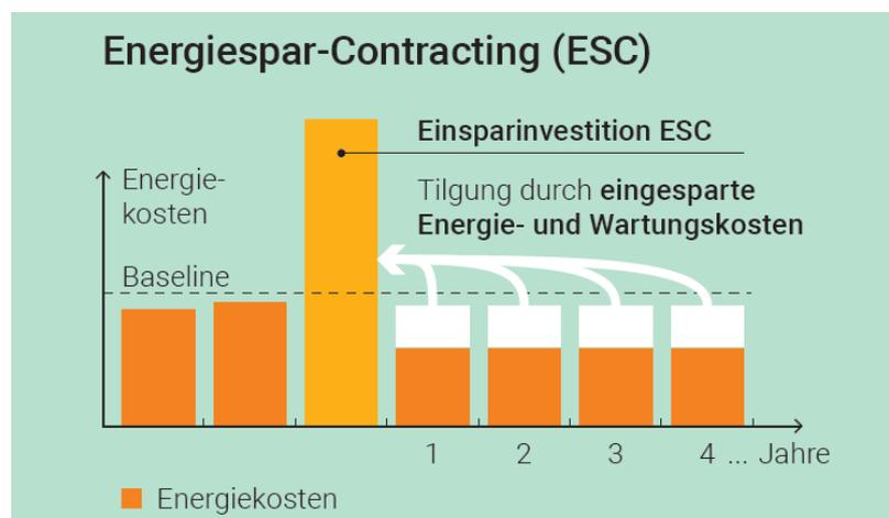
Abbildung 3: Energiespar-Contracting (ESC). Quelle: KEA-BW
