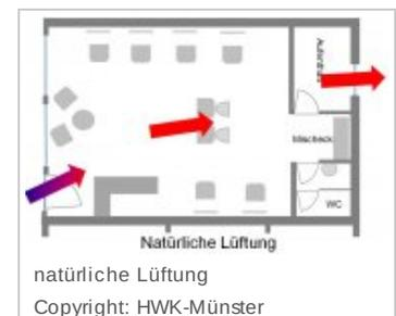
Wenn eine Querlüftung nicht zu realisieren ist, muss eine künstliche Entlüftung mit Ventilatoren
