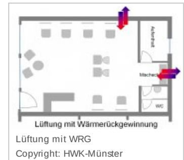
Beim Gegenstromprinzip streicht die warme Abluft in einem Wärmetauscher - nur durch eine dünne, wärmeleitende Platte oder Folie getrennt - an der kalten Zuluft vorbei. Auf dem Weg aneinander vorbei wird die Wärmeenergie von der warmen auf die kalte Luft übertragen. Da diese Luftkanälchen sehr dünn sind, reagieren sie sehr empfindlich auf Stäube. Daher müssen sehr gute Filter eingesetzt werden, die auch regelmäßig zu tauschen sind.
