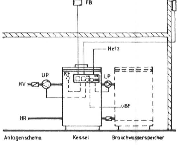
**Anschluß der Fernbedienung (Raumtemperaturfühler) FB für die nebenstehenden Heizungsregelungen.**
