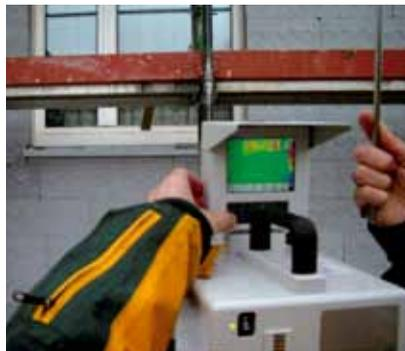
*Baubegleitende Qualitätssicherung mittels Infrarot-Thermografie*
