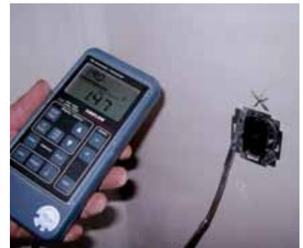
*Gebäudetechnik: Lecks an Elektrolehrröhren und -Unterputzdosen sowie Durchbrüchen von Leitungen*
