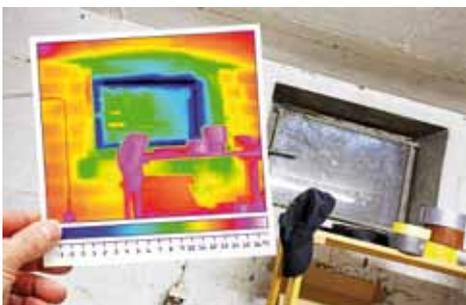
Insbesondere bei Fenster und Türen müssen Schlagregenschutz, Luftdichtheit und auch die minimale Oberflächentemperatur gegeben sein. Werden Fenster und Türleibungen nicht gedämmt ist die Wahrscheinlichkeit einer Schimmelpilzbildung aufgrund der zu niedrigen Oberflächentemperatur sehr groß.
