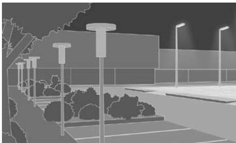
**Mastleuchten und Lichtstelen** dienen als technische und dekorative Außenleuchten zur Beleuchtung von Fahrbahnen, Wegen und Plätzen. Zum Teil lassen sich funktionale Elemente wie Anschlüsse für Gas, Strom, Wasser etc. mit den Leuchten kombinieren.
