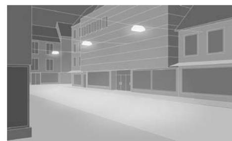
**Überspannungsleuchten** sind ideale Problemlöser. Sie können mittig über Straßen oder Gassen installiert werden und diese lichttechnisch optimal ausleuchten.
