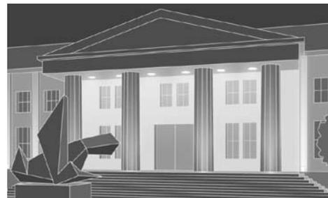
**Deckeneinbau-, Deckenaufbauleuchten** sorgen für Licht in Arkaden, unter Vordächern oder Vorsprüngen. Zurückhaltend in die Architektur integriert oder auffällig als dekorative Leuchte, lassen sich mit ihnen Lichträume im Außenbereich gestalten.
