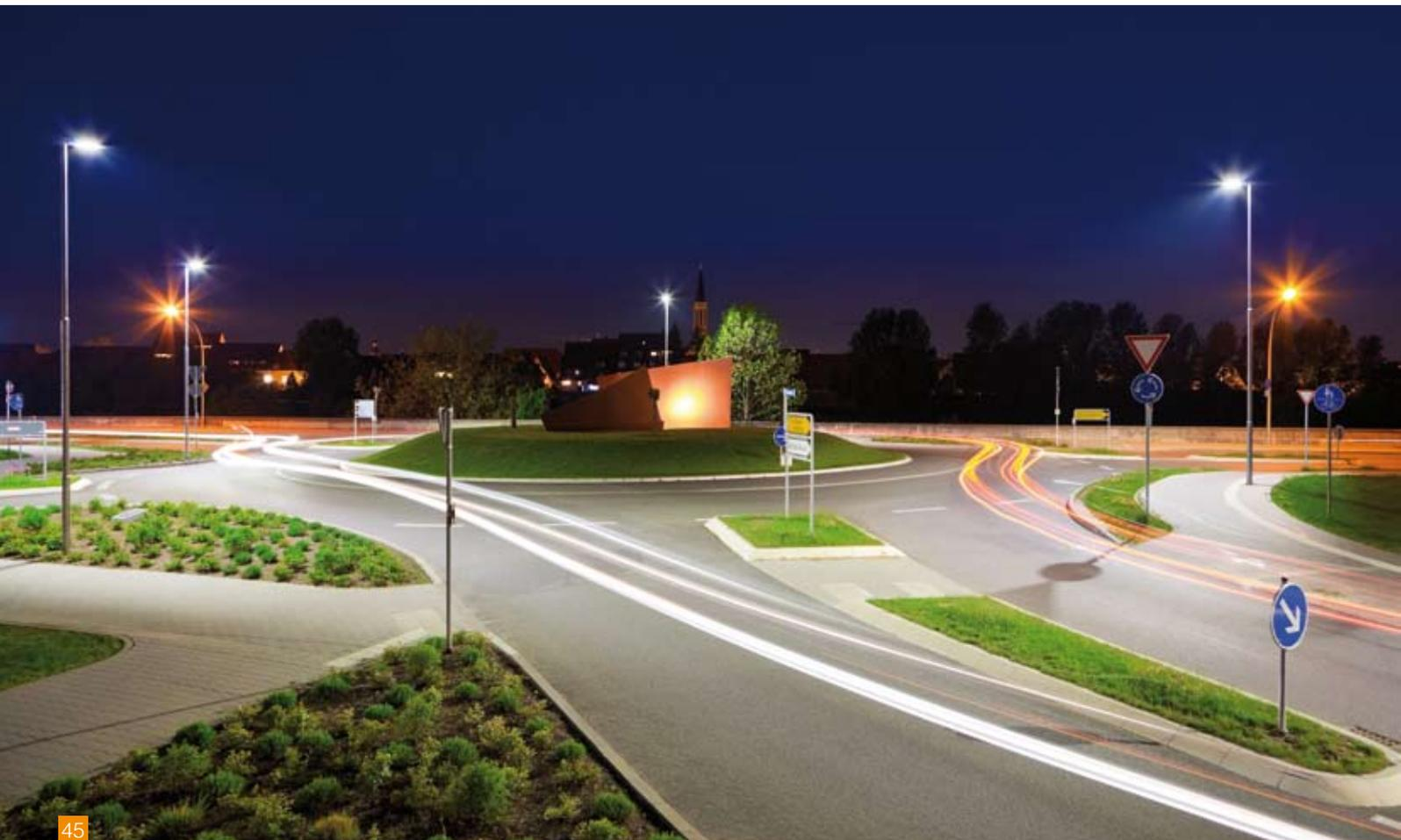
bilden anstatt der Leuchtdichte die mittlere horizontale Beleuchtungsstärke sowie die Gleichmäßigkeit den Bewertungsmaßstab. Dabei ist zu beachten, dass das höhere Beleuchtungsniveau nicht mit stärkerer Blendung erkauft wird, sondern Leuchten mit gutem Sehkomfort eingesetzt werden.
