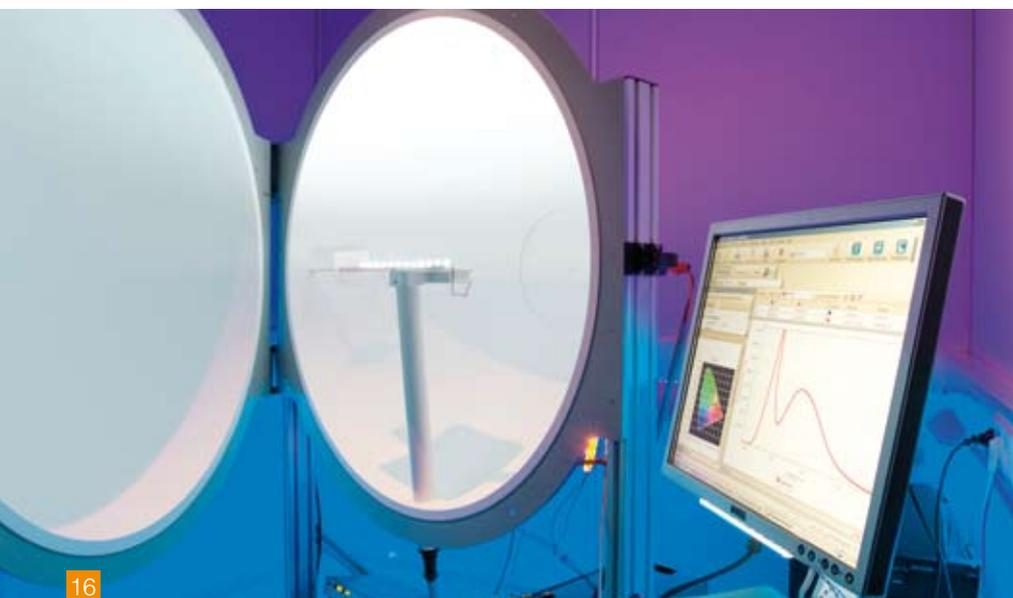
[16] Mit der „Ulbricht-Kugel“ wird der ungleichförmig verteilte Lichtstrom aus allen Richtungen gesammelt, um die Beleuchtungsstärke zu messen. Das Photometer im Inneren der Kugel misst die Beleuchtungsstärke in Lux bzw. den Lichtstrom in Lumen.
