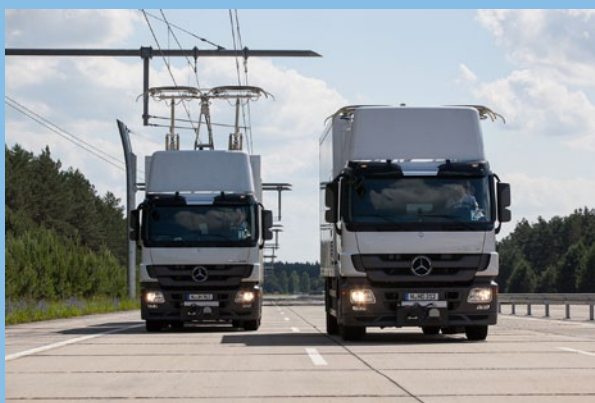
„Trolley-Lkw“ auf einer Teststrecke mit elektrischer Oberleitung Quelle: Siemens
