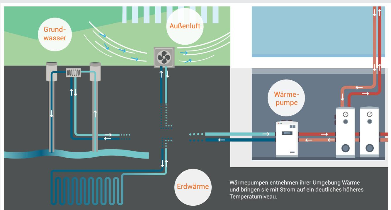
Wärmepumpen entnehmen ihrer Umgebung Wärme und bringen sie mit Strom auf ein deutliches höheres Temperaturniveau.
