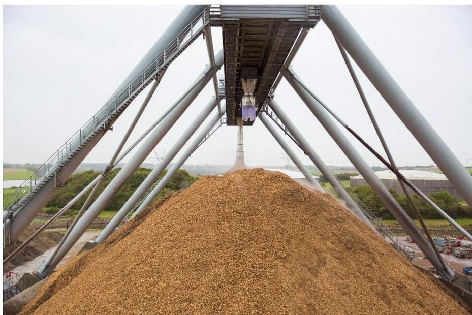
Abbildung 4: Mehrere große dänische KWK-Anlagen wurden von Kohle auf Biomasse umgestellt, wodurch der Verbrauch an importierten Holzpellets und Holzhackschnitzeln erheblich zunahm. Bildquelle: <https://orsted.com/da/Media/Press-kit/Images-and-logo>
