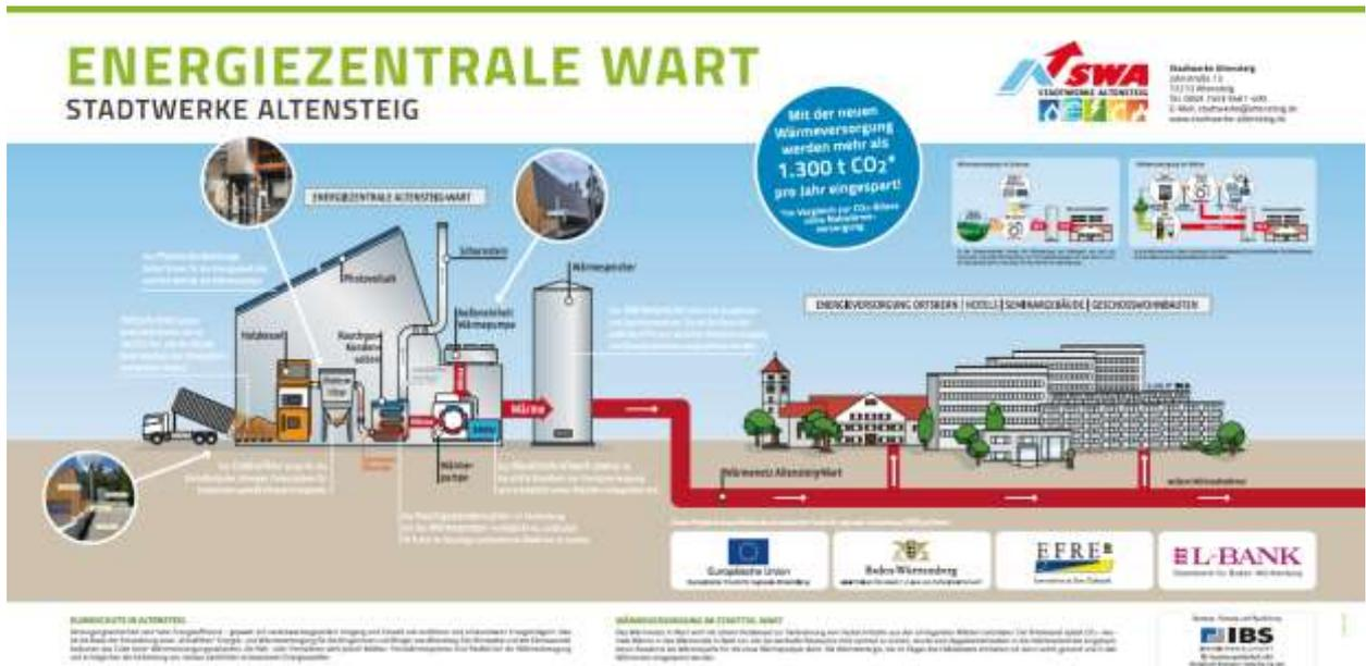
**Abb. 26: Beispiel Heizzentrale Altensteig-Wart mit Hackschnitzelheizung und Wärmepumpe (Sommer Außenluft / Winter Abgaskondensation)**
