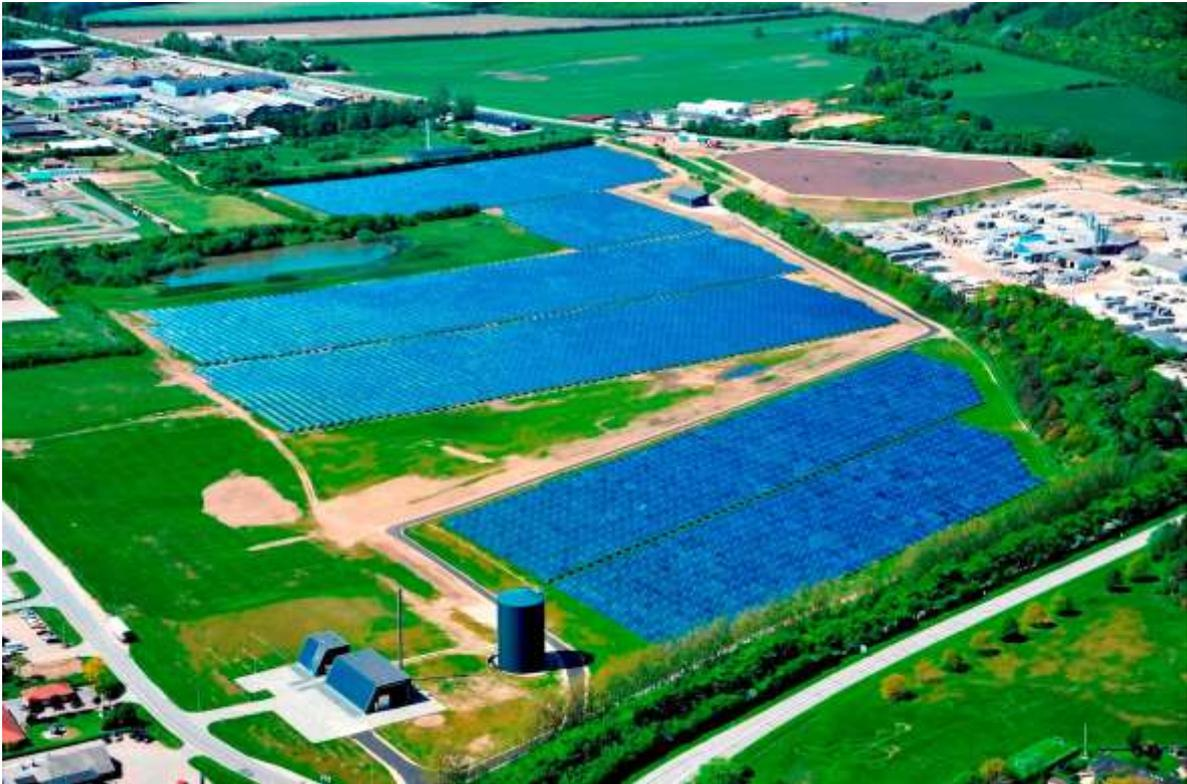
**Abb. 22: Solarthermieanlage mit rd. 200.000 m<sup>3</sup> Erdbeckenwärmespeicher (Wärmespeicher oben rechts im Bild/ Bild: [www.vojensfjernvarme.dk](http://www.vojensfjernvarme.dk))**
