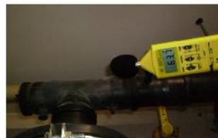
Hoher Schalldruckpegel am Oberteil von Schalldämpfer mit 64dB
