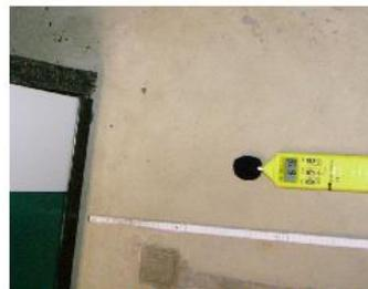
Hoher Schalldruckpegel in Bodennähe, Spitzenwert hinten rechts mit 68dB
