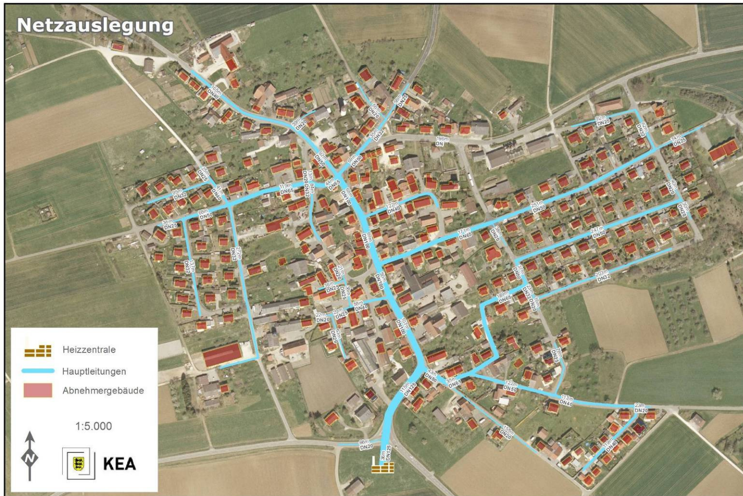
Abbildung 4: Beispiel für Netzauslegung 1)
